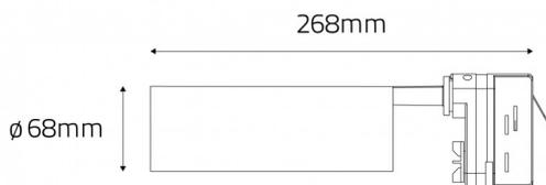
Tracklight de alta qualidade, projetado para atender às exigências de ambientes modernos e sofisticados. Com IK03 e IP20, é ideal para aplicações internas, proporcionando resistência e durabilidade. O ângulo de abertura de 38°, oferece uma iluminação direccional e eficiente, perfeita para destacar áreas ou elementos específicos do espaço.
