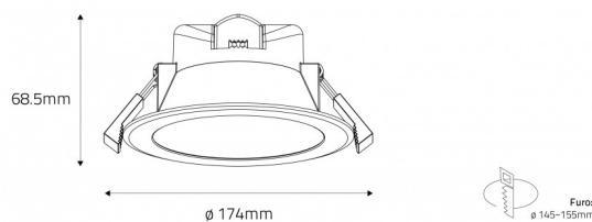
Disponível em potências entre 7W e 25W, oferece um fluxo luminoso de 560 a 2450 lumens e um amplo ângulo de abertura de 90º. Com um CRI superior a 80, garante uma excelente reprodução de cores, enquanto a tecnologia *No Flickering* proporciona uma luz constante e confortável, sem cintilação.
