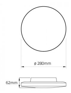
Desenvolvida com corpo em Polipropileno de IP55 e IK08 a Sura foi construída para durar!
