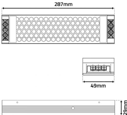
Fonte de Alimentação METAL Slim DIMÁVEL V.1 para Fita LED 12Vdc.
